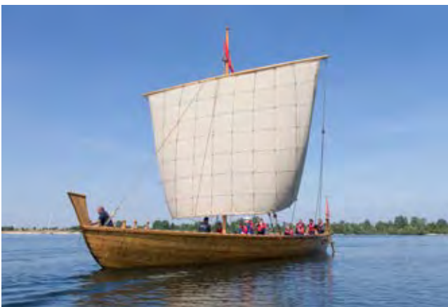
Die erste Testfahrt der 18 Meter langen und sechs Tonnen schweren Minerva Tritonia im Juni 2018. Foto: Dominik Schmitz/LVR Medienzentrum
